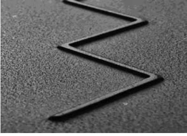
图 6 微小 W 型肋实物细节图(TLC)
